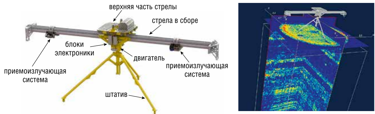
Внешний вид приемоизлучающей системы Acoustic Corer (слева) и пример получаемых данных (справа) [по Cahill, 2016]
