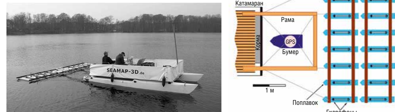
Внешний вид приемоизлучающей системы SEAMAP-3D (слева) и схема (справа) [по Müller et al., 2009]
